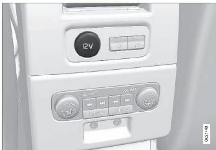
Presa da 12 V nel tunnel, sedile posteriore.
