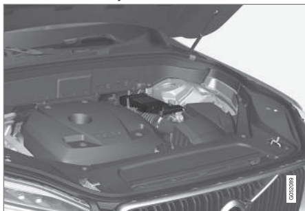
A 12 voltos segédakkumulátor egy dobozban helyezkedik el a felfüggesztéstestoronnyal mellett.
