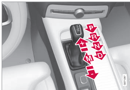
A nagy sebességváltó kar és a fokozathelyzetek áttekintése.
