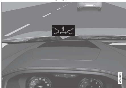
Távolságfigyelmeztetés szimbólum a szélvédőn szélvédőre vetített kijelzővel.
