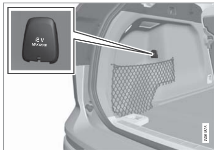
カーゴスペースの12V 電源ソケット*
