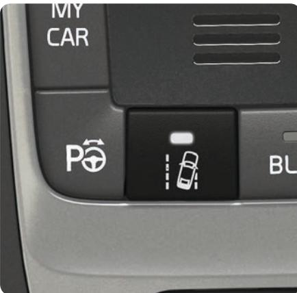
Wenn das Fahrzeug im Begriff ist, einen Seitenstreifen zu überfahren, wird der LKA aktiv eingreifen und durch ein schwaches Drehen des Lenkrads auf die Fahrbahn zurücksteuern. Wenn das Fahrzeug einen Seitenstreifen überfährt, wird der LKA eine Warnung mit pulsierenden Vibrationen im Lenkrad ausgeben.
