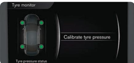
Eine Kalibrierung muss nach jedem Reifenwechsel und nach jeder Änderung des Reifendrucks durchgeführt werden. Wenn das Symbol (⚠) aufleuchtet, muss der Reifendruck kontrolliert und das System kalibriert werden. Gehen Sie dazu wie folgt vor:
