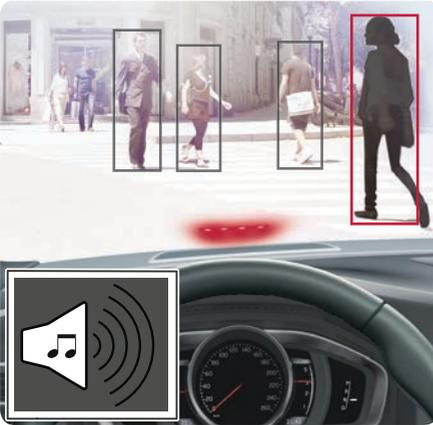
Das Fahrzeug verfügt über ein Unfallwarnsystem mit Bremsautomatik sowie Fußgänger- und Radfahrererkenkung, das vor Fahrzeugen, Radfahrern und Fußgängern warnen sowie das Fahrzeug abbremsen und/oder zum Stehen bringen kann.
