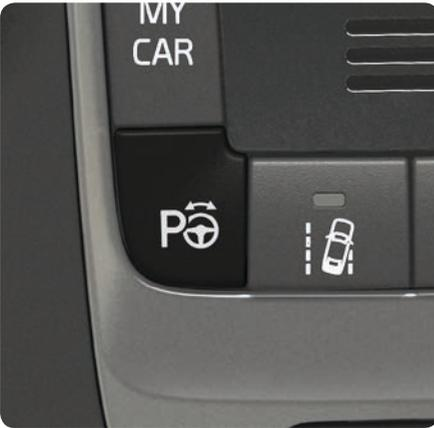
PAP kontrolliert den verfügbaren Freiraum und steuert das Fahrzeug entsprechend. Ihre Aufgabe besteht darin, die Umgebung des Fahrzeugs im Blick zu behalten, den Gang einzulegen, die Geschwindigkeit zu regeln sowie zu bremsen bzw. anzuhalten.
