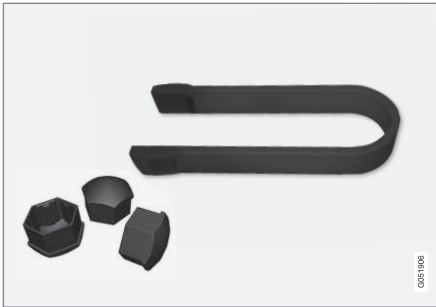
Verktyg för borttagning av plasthattar på hjulskruvarna.
