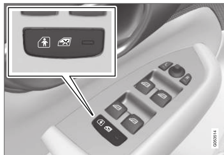
Przycisk do elektrycznej aktywacji i dezaktywacji.
