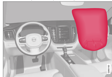
Czołowa poduszka powietrzna pasażera przedniego fotela.
