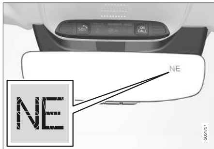
Wewnętrzne lusterko wsteczne z wbudowanym kompasem.
