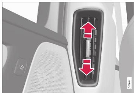
Регулятор вентиляционного сопла 2 .
