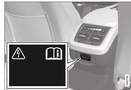
Электрическое гнездо в тоннельной консоли, заднее сиденье.
