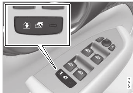
Кнопка для активирования и отключения электрической блокировки.
