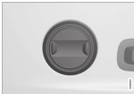
Регулятор в автомобилях с двухпозиционной опорой поясницы*.
