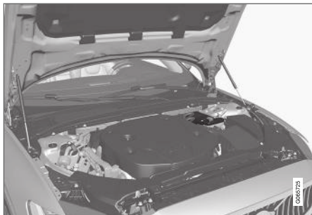
Вспомогательный аккумулятор установлен в моторном отсеке.
