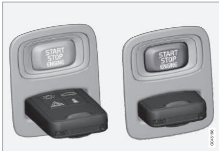
Startlås med fjärrnyckel utdragen/intryckt.
