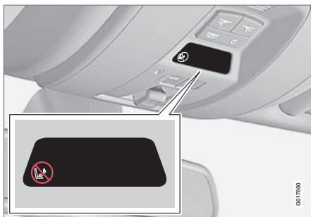
Indikering som visar att passagerarplatsens krockkudde är aktiverad.
