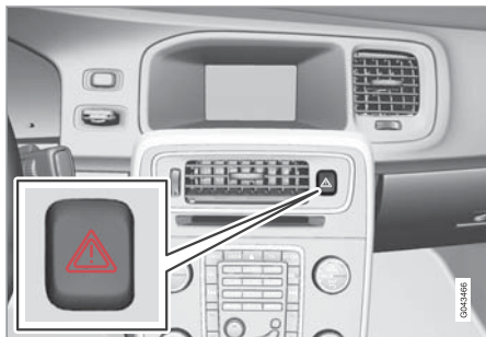
非常点滅灯ボタン
