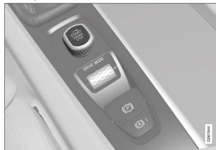
Ручка запуска в тоннельной консоли.
