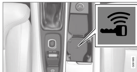
Резервное считывающее устройство в подстаканнике.
