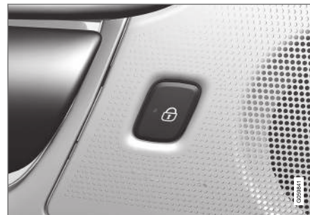
Кнопка для запирания с индикаторной лампой на задней двери.
