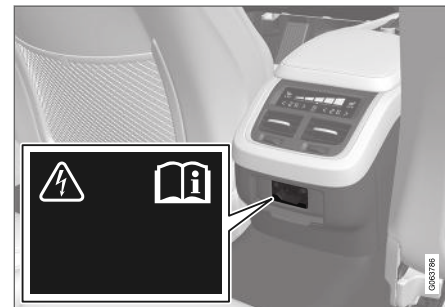
Электрическое гнездо в тоннельной консоли, заднее сиденье.
