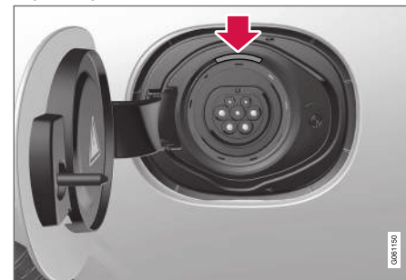
Положение LED-лампы в зарядном гнезде автомобиля.
