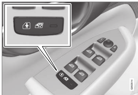
Кнопка для активирования и отключения электрической блокировки.
