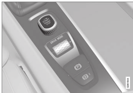
Ручка запуска в тоннельной консоли.
