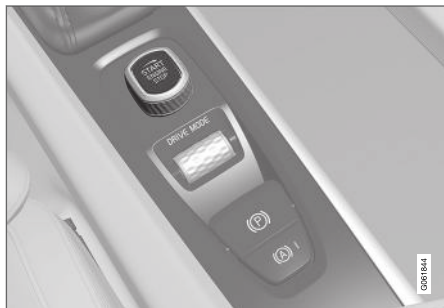
Ручка запуска в тоннельной консоли.
