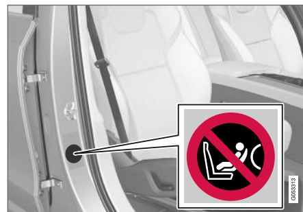
Табличка на дверной стойке со стороны пассажира. Наклейка видна, когда открыта дверь пассажира.
