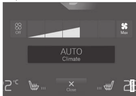
Кнопка автоматического режима на панели климат-контроля.
