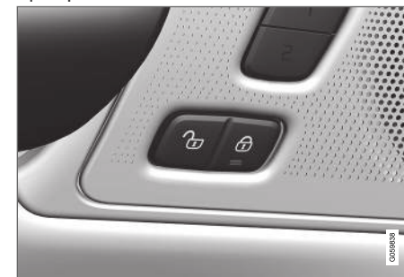
Кнопка для запирания и отпирания в передней двери и индикаторная лампа.
