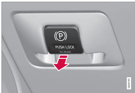
Commande de frein de stationnement - desserrage.
