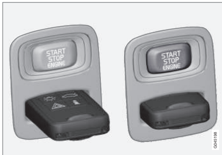
Contacteur d'allumage avec télécommande retirée/insérée.
