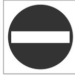
Se o motorista entrar em uma estrada marcada com uma placa lateral de não entrar, ele é alertado com um símbolo piscando com a placa<sup>89</sup> no visor do motorista.
