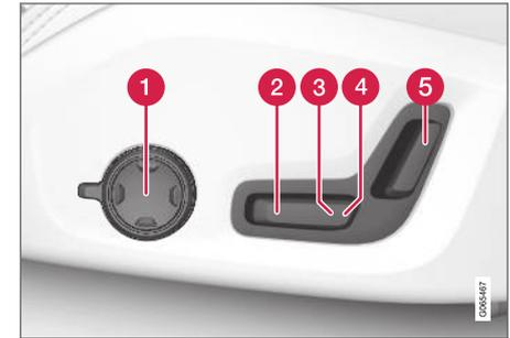
A ilustração mostra os controles de um veículo com suporte lombar de 4 partes\*. Veículos com suporte lombar duplo\* não possuem o controle multifuncional giratório.
