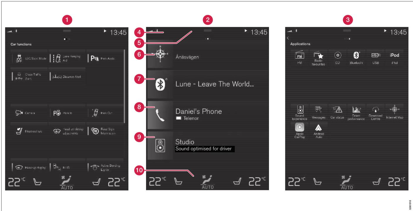
Três das vistas básicas do visor central. Deslize para a direita ou para a esquerda para acessar a vista de funções ou a visualização de aplicativos<sup>9</sup>.
