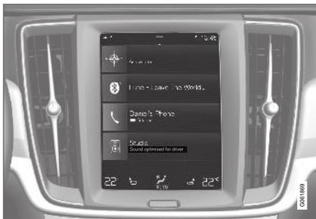
Muitas das funções principais do veículo são comandadas a partir do visor central, uma tela sensível ao toque que reage aos movimentos. Por essa razão, a quantidade de botões e controles físicos no veículo é mínima. A tela pode ser utilizada com ou sem luvas.
