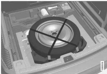
O pneu sobressalente está colocado embaixo do assoalho da área de carga, fixado com duas cintas. O bloco de espuma contém todas as ferramentas necessárias para a substituição da roda.
