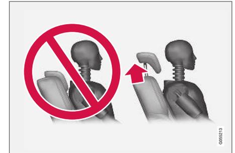
O apoio de cabeça do lugar central deve ser regulado de acordo com a altura do passageiro, cobrindo preferencialmente toda a nuca. Desloque manualmente para cima conforme a necessidade.
