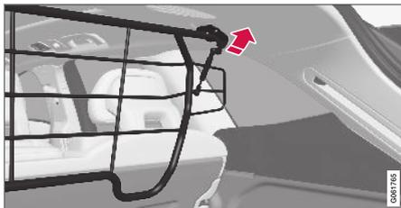
Coloque as fixações da grade de proteção nas fixações do teto.
