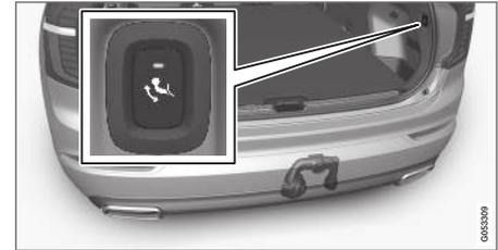
Abra a tampa do porta-malas. Na parte de trás do painel lateral direito da área de carga existe um botão para retração e rebatimento da barra de reboque. Para que a função de rebatimento esteja ativa é necessário que esteja acesa uma luz indicadora laranja no botão.
