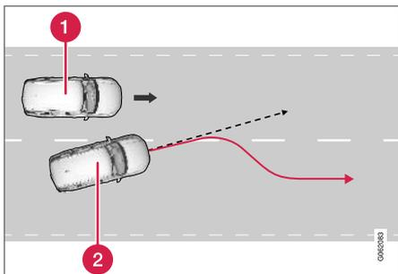
A função pode ajudar trazendo o veículo de volta para a sua faixa de rodagem.
