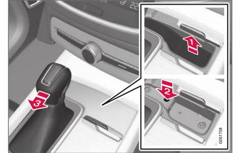
Se não for possível conduzir o veículo, por exemplo, devido a bateria descarregada, é necessário colocar o seletor de marchas na posição **N** para que seja possível deslocar o veículo.
