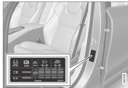
O adesivo exibe a designação dos pneus instalados na fábrica, assim como os limites de carga e a pressão dos pneus.
