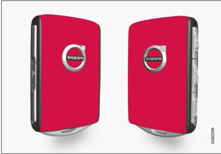
Uma Red Key pode definir a velocidade máxima do veículo, gerar lembretes de velocidade e determinar o volume máximo do sistema de alto-falantes. Além disso, alguns dos sistemas de suporte ao motorista do veículo ficam sempre ativos. As demais funções da chave são as mesmas que em uma chave normal.
