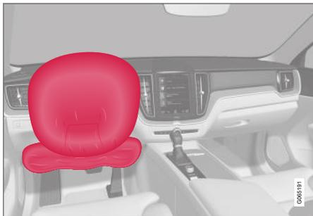
Airbag do volante e airbag do joelho<sup>1</sup> no lado do motorista no banco dianteiro.
