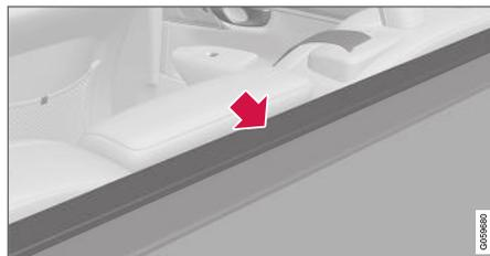
Assegure-se de que o painel de cobertura dianteiro está virado para baixo atrás do encosto antes de a caixa ser colocada no lugar.
