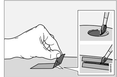
1. Fixe um pedaço de fita adesiva sobre a superfície danificada. Em seguida, puxe a fita de modo que os eventuais restos da tinta venham presos à fita.
