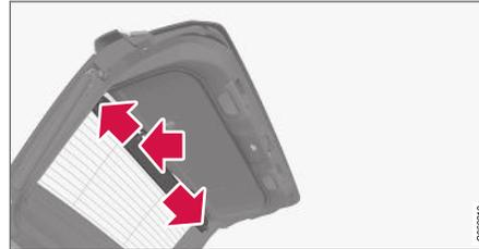
Solte cuidadosamente o painel de cobertura da fixação de um dos lados da tampa do porta-malas, repita depois no outro lado. Se necessário, aperte ligeiramente o painel de cobertura para torná-lo mais flexível e facilitar a remoção.
