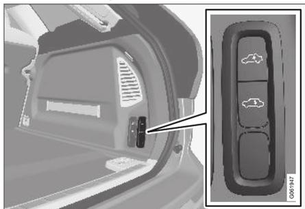
Utilize os botões na área de carga para regular a altura da seção traseira e facilitar a carga e descarga ou a conexão ou desconexão de um reboque.
