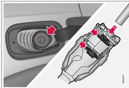
É importante abastecer o bico da bomba mais do que as duas aberturas do tubo de enchimento antes de iniciar o abastecimento do veículo.
