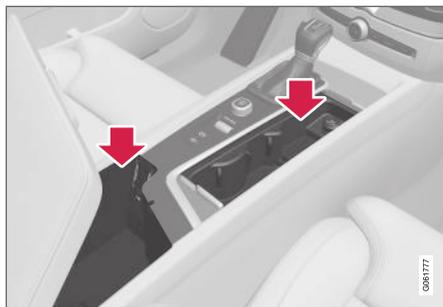
Espaços para armazenamento com porta-copos, tomada elétrica e entrada USB no console de túnel.
