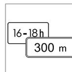
Algumas velocidades são válidas após, por exemplo, determinada distância ou durante determinadas horas do dia. O motorista é alertado para estas condições com um símbolo de uma placa adicional sob o símbolo com a velocidade. O símbolo adicional do visor do motorista exibe então "DIST" ou "TIME".
