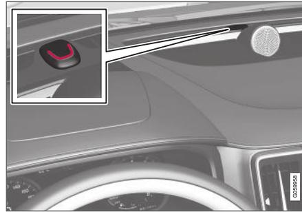
Um LED vermelho no painel de instrumentos pisca uma vez a cada dois segundos quando o veículo está travado e o alarme está ativado.
