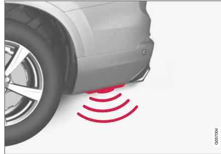
Para ativar a abertura ou fechamento com a ajuda do movimento do pé em veículo com chapa de proteção faz-se um movimento de pontapé a partir do lado do veículo. Um dos controles remotos do veículo deve estar dentro do alcance (cerca de 1 metro (3 pés)) para que a abertura e o fechamento sejam possíveis.
