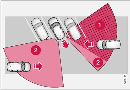
Em uma vaga de estacionamento inclinado o CTA pode ficar completamente "cego" em relação a um lado.
