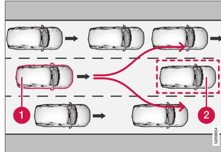
O seu veículo (1) não "enxerga" qualquer hipótese de evitar o veículo à frente (2) e freia automaticamente mais cedo.
