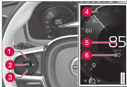
Para desativar e colocar o Limitador de velocidade em modo de espera:
