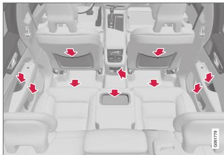
Compartimento de armazenamento no painel da porta, porta-copos\* no encosto do assento central, bolso para armazenamento\* no encosto dianteiro, tomada elétrica no console de túnel e compartimento de armazenamento sob o banco.
