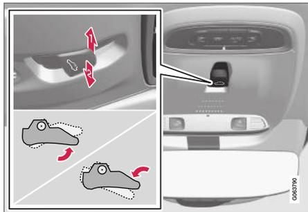
Posição de ventilação, vertical na margem traseira.
