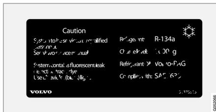
3 Adesivo sistema A/C para veículos com arrefecedor R134a.
