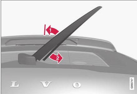
Levante o braço do limpador do para-brisa do vidro e puxe a parte inferior da palheta do limpador para a direita.
