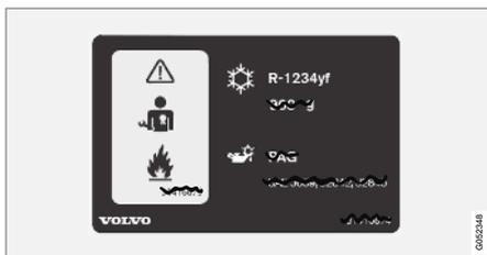
2 Adesivo sistema A/C para veículos com arrefecedor R1234yf.
