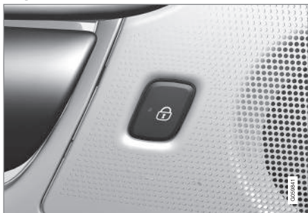
Låseknop med indikeringslampe i bagdør.
