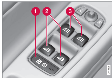
A vezetőajtó vezérlőpanelje.
