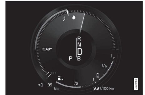
Den elektriske motoren kan ikke levere den mengden motoreffekt som blir krevd og forbrenningsmotoren starter.
