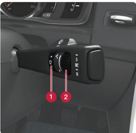
Desloque a alavanca para baixo para iniciar os limpa pára-brisas e para cima para uma passagem única.
