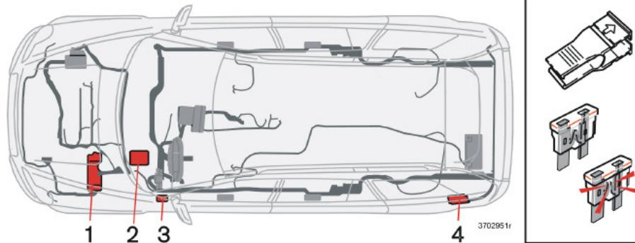
Per impedire che l'impianto elettrico dell'automobile venga danneggiato da cortocircuiti e sovraccarichi, tutte le funzioni elettriche ed i componenti sono protetti da fusibili.
