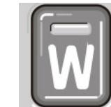
Con il tasto **W** a lato della leva selettrice si inserisce e disinserisce il programma invernale **W**. Nel quadro comandi combinato viene visualizzato il simbolo **W**
