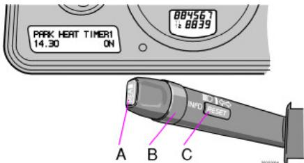
L'elettronica dell'automobile calcola da sola il momento di avvio sulla base della temperatura esterna. Se tale temperatura supera i 25 °C, non avviene nessun riscaldamento. A temperature dai –10 °C in giù, il tempo di funzionamento massimo del riscaldatore di parcheggio è di 60 minuti.
