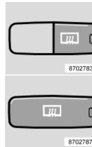
Utilizzare il riscaldamento per rimuovere ghiaccio e condensa da lunotto e specchietti retrovisori. Premendo l'interruttore si avvia contemporaneamente il riscaldamento del lunotto e degli specchietti retrovisori. Il LED nell'interruttore si accende. Un timer incorporato disinserisce automaticamente il riscaldamento degli specchietti retrovisori dopo circa 4 minuti e quello del lunotto dopo circa 12 minuti.
