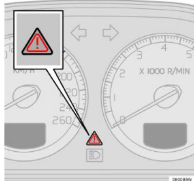
**NOTA!** Quando il messaggio "SCADENZA TAGLIANDO" viene visualizzato, la spia d'allarme ed il messaggio si spengono con il tasto READ o spariscono automaticamente dopo 2 minuti.
