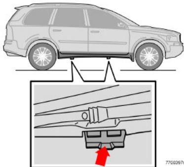
*Gli attacchi del martinetto sono centrati sotto il bordo inferiore delle portiere.*
