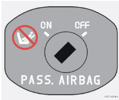
Commutatore SRS in posizione Off.
