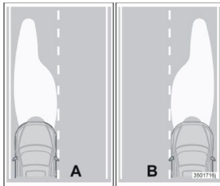
A. Fascio di luce per il traffico con guida a sinistra B. Traffico con guida a destra
