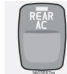
Premere il pulsante per attivare il condizionamento dell'aria nella sezione posteriore dell'abitacolo. Il condizionamento dell'aria nella sezione posteriore
