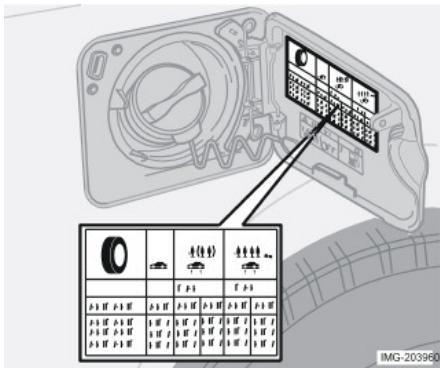
Guidando con una pressione pneumatici non corretta si alterano le caratteristiche di guida dell'automobile e si può aumentare l'usura del pneumatico. I pneumatici si riscaldano dopo pochi chilometri e la loro pressione aumenta, quindi non è necessario scaricare aria se la pressione è stata controllata a pneumatici caldi. Tuttavia se la pressione è troppo bassa, deve essere aumentata.
