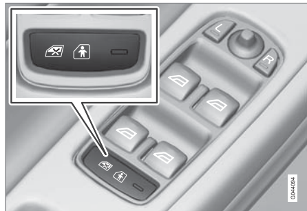
運転席ドアのコントロールパネル
