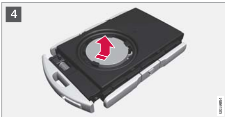
4 แบตเตอรี่ (+) ให้หน้าขึ้น ถอดแบตเตอรี่ออกตามภาพประกอบ
