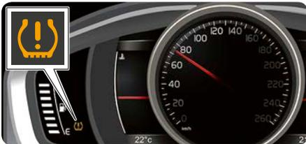
更換輪胎或改變胎壓後，務必進行校正。燈光明亮時，<sup>(\*)</sup>系統需要校正。依據下列步驟進行：
