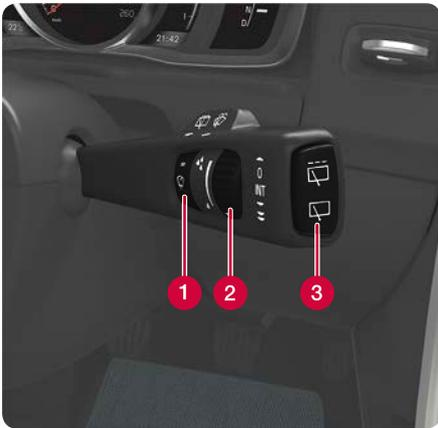
將撥桿向下移可啟動擋風玻璃雨刷，向上移可刷動一次。
