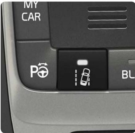
當汽車將要跨越邊線時，LKA 會在方向盤上施加輕微的轉向扭力，主動將汽車轉回車道內。若汽車跨越了邊線，LKA 會透過方向盤的震動向您提出警告。
