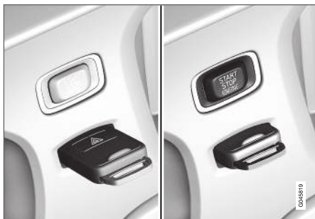
Aizdedzes slēdzis ar izvērstu/ievietotu tālvadības pults atslēgu.
