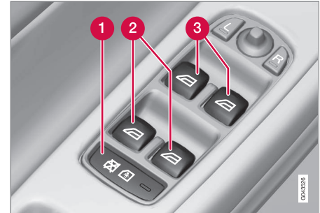
Säädinpaneeli kuljettajan ovessa.
