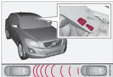
Fenêtre d'émission et de réception du capteur laser<sup>12</sup>.
