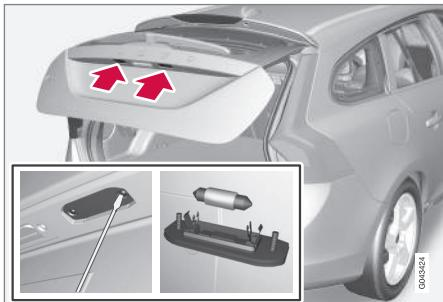
1. Desserrez les vis avec un tournevis.
