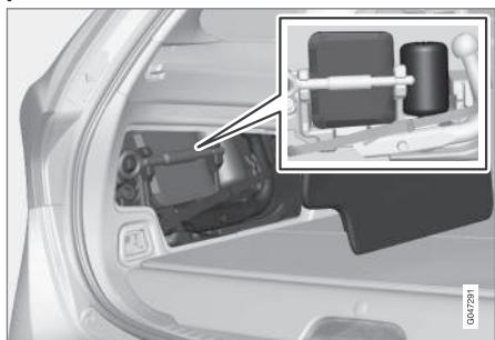
Le kit de réparation provisoire de crevaison se trouve derrière la trappe située sur le côté gauche du compartiment à bagages.
