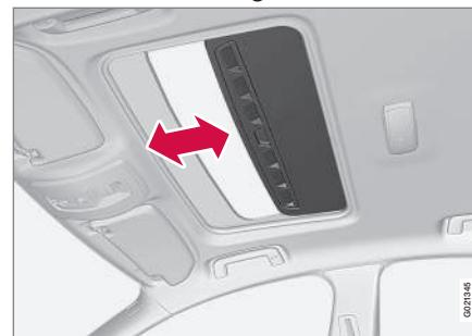
Une pression longue sur le bouton de verrouillage permet de fermer le toit ouvrant et toutes les vitres, référez-vous à Télécommande - fonctions (p. 169) et Verrouillage/déverrouillage - de l'intérieur (p. 183). Les portes et le hayon sont verrouillés. Si vous devez interrompre la fermeture, appuyez à nouveau sur le bouton de verrouillage.
