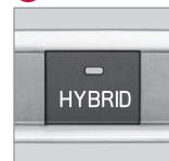
Ce mode de conduite est celui sélectionné par défaut au démarrage. Le système de gestion utilise les moteurs électrique et diesel, individuellement ou en parallèle, et calcule l'utilisation optimale pour les performances, la consommation de carburant et le confort.
