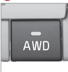
Ce mode active l'entraînement à quatre roues motrices et améliore l'adhérence et la tenue de route. Ce mode est principalement destiné à une conduite à basse vitesse sur chaussée glissante mais l'entraînement à quatre roues motrices a également un effet stabilisateur à grande vitesse.
