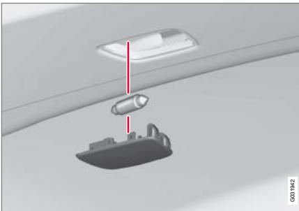
1. Délogez le bloc optique en y insérant un tournevis et en forçant légèrement sur celui-ci.
