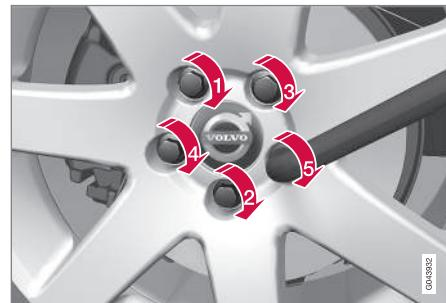
4. Serrez fermement les boulons de roue en croix et de manière alternée. Il est important que les boulons de roue soient correctement serrés. Serrez à 140 Nm. Vérifiez le couple de serrage des écrous à l'aide d'une clé dynamométrique.
