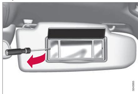
1. Insérez un tournevis sous la lentille et faites levier avec précaution sur la patte, sur le bord.
