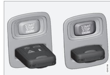
Contacteur d'allumage avec télécommande retirée/insérée.
