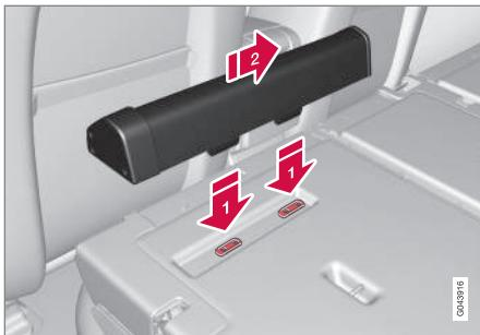
La cassette du filet de protection en deux parties se fixe sur l'arrière du dossier. La cassette la plus étroite se fixe sur le côté gauche (vue du hayon).
