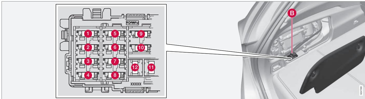
Le boîtier est placé derrière la garniture, du côté gauche.
