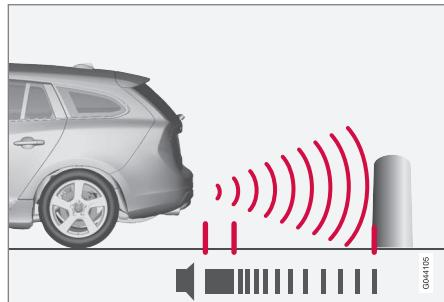
La zone de détection derrière la voiture est d'environ 1,5 m. Le signal sonore indiquant un obstacle à l'arrière provient de l'un des haut-parleurs arrière.
