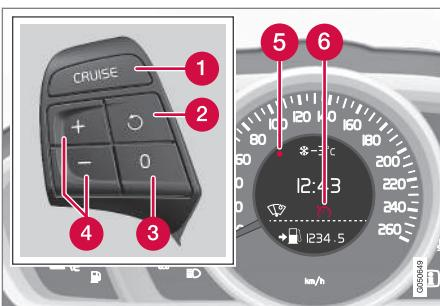
Clavier au volant et combiné d'instruments dans une voiture **sans** limiteur de vitesse<sup>4</sup>.
