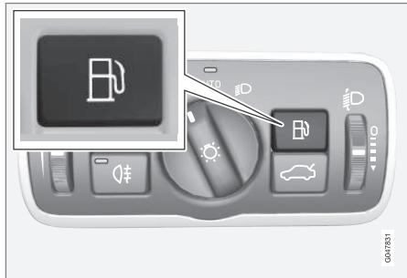
La trappe du réservoir de carburant est déverrouillée et ouverte grâce au bouton du panneau d'éclairage. La trappe s'ouvre lorsque vous relâchez le bouton.
