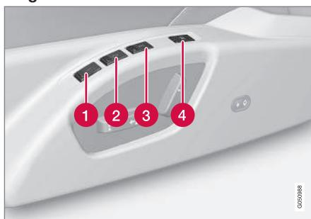
La fonction mémoire enregistre les réglages des sièges et des rétroviseurs extérieurs.
