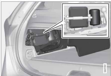
Les ampoules sont accessibles après avoir retiré le kit de réparation provisoire de crevaison.
