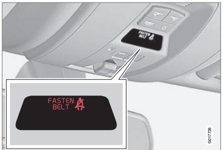
Le rappel sonore dépend de la vitesse et parfois du temps. Le rappel lumineux est situé dans la console du plafond et dans le combiné d'instruments (p. 67).
