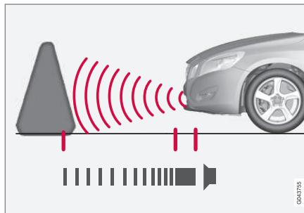
La zone de détection devant la voiture est d'environ 0,8 m. Le signal sonore indiquant un obstacle à l'avant provient de l'un des haut-parleurs avant.
