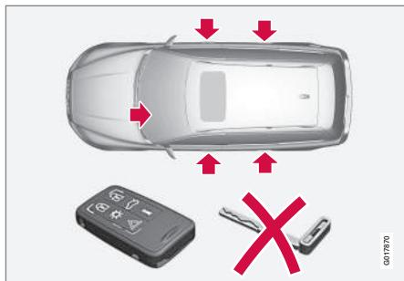
Cela signifie que la télécommande sans lame de clé ne peut servir qu'à activer/désactiver l'alarme (p. 189), ouvrir les portes et conduire la voiture.
