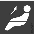
Arrivée d'air sur le pare-brise, de la buse de dégivrage, et sur les vitres latérales. Une certaine quantité d'air passe par les buses de ventilation.        | pour éviter la formation de buée et de givre par temps froid et humide (vitesse de ventilateur suffisante). |
