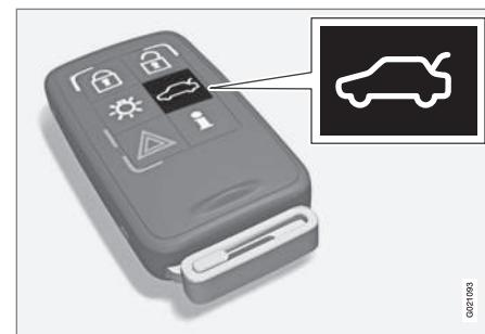
Grâce au bouton
