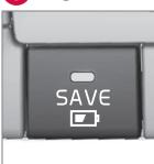
Cette fonction active la charge de la batterie hybride et permet d'éviter que le niveau d'énergie n'atteigne une capacité correspondant à une autonomie inférieure à environ 20 km avec l'entraînement électrique. L'idée est d'économiser l'énergie pour une situation plus adaptée à l'entraînement électrique, par exemple en milieu urbain.
