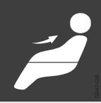
Arrivée d'air au niveau de la tête et de la poitrine par les buses de ventilation du tableau de bord.                                                         | pour un rafraîchissement optimal par temps chaud.                                                           |
