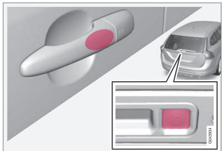
La zone tactile sur la poignée extérieure des portes et le bouton caoutchouté près du bouton gainé de caoutchouc du hayon.
