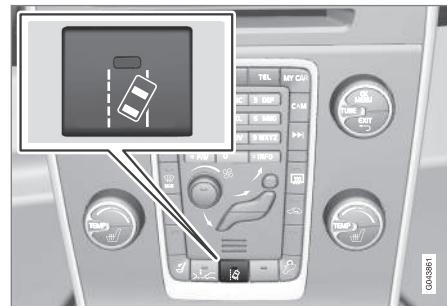
Le LDW est activé et désactivé par une touche située sur la console centrale. Une diode sur le bouton s'allume lorsque la fonction est activée.
