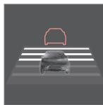
Il est possible de choisir parmi différentes distances temporales au véhicule qui précède. Elles sont représentées sur le combiné d'instruments par des traits horizontaux (entre 1 et 5) - plus ils sont nombreux, plus la distance temporelle est longue. Un trait correspond à environ 1 seconde jusqu'au véhicule qui précède et 5 traits à environ 3 secondes.
