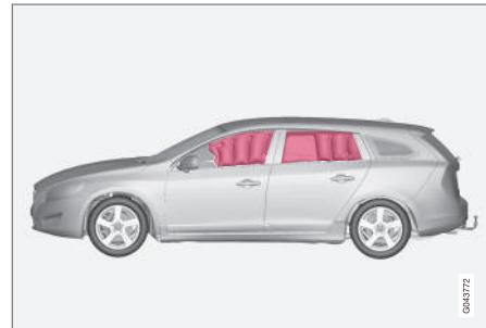
Le rideau gonflable IC (Inflatable Curtain) est un composant du système SIPS (p. 39) et du système de coussins gonflables (p. 34). Le rideau gonflable est dissimulé dans la garniture de plafond des deux côtés de la voiture et il protège les occupants des places extérieures. Lors d'une forte collision, les capteurs réagissent et le rideau gonflable se gonfle.
