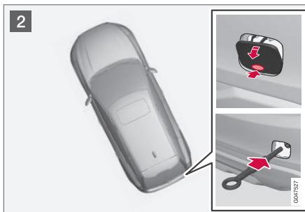
1 Sortez l'œillet de remorquage situé derrière le panneau du côté gauche du compartiment à bagages.
