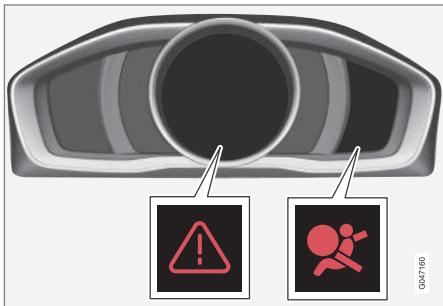
Triangle de pré-signalisation ainsi que témoin d'avertissement pour système d'airbag (p. 34) dans le combiné d'instruments.
