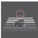
Il est possible de choisir parmi différentes distances temporelles au véhicule qui précède. Elles sont représentées sur le combiné d'instruments par des traits horizontaux (entre 1 et 5) - plus ils
