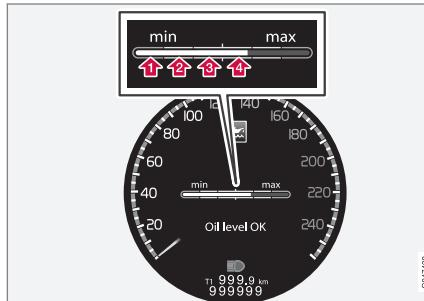
Les chiffres 1 à 4 représentent le niveau de remplissage. Ne rajoutez pas plus d'huile si le niveau de remplissage (3) ou (4) s'affiche. Le niveau de remplissage recommandé est de 4. Message et pictogramme à l'écran.
