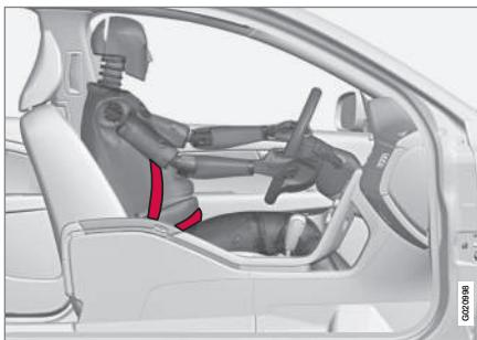
La ceinture de sécurité doit se coller contre l'épaule et la partie diagonale doit se placer entre les seins et sur le côté du ventre.
