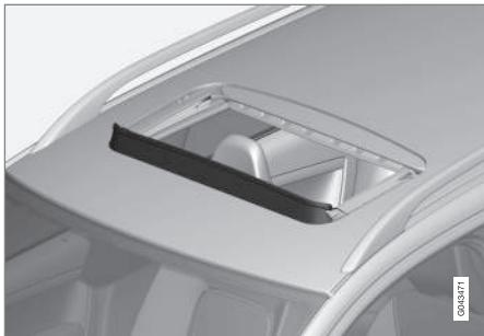
Le toit ouvrant est doté d'un déflecteur qui se déploie lorsque le toit ouvrant est ouvert.
