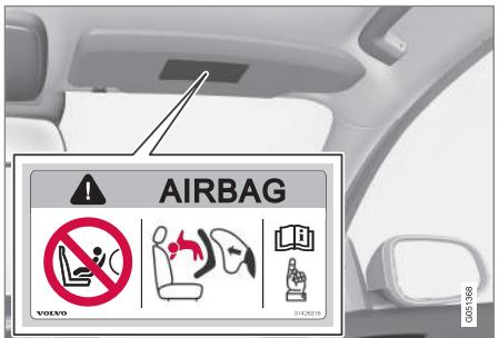
Alternative 1 : placement de l'autocollant de coussin gonflable sur le pare-soleil du côté passager
