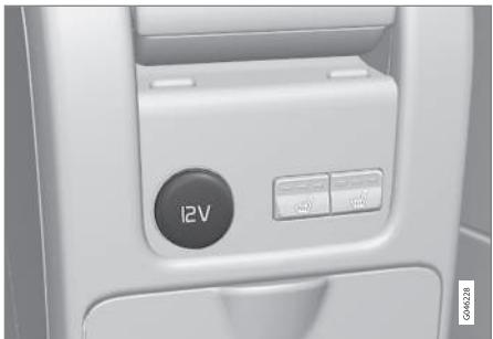
*Prise 12 V dans la console du tunnel, banquette arrière.*
