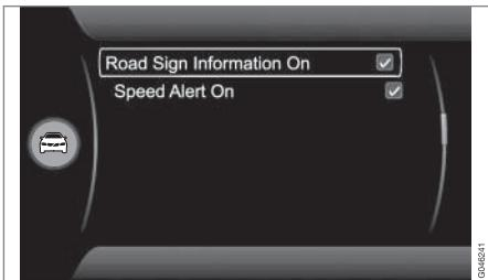
L'affichage des panneaux de limitation de vitesse sur le combiné d'instruments peut être désactivé. La fonction peut être activée/désactivée dans le système de menu **MY CAR**. Pour une description du système de menu, voir **MY CAR** (p. 118).
