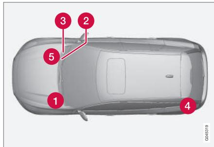
Emplacement des centrales sur une voiture avec conduite à gauche. Pour les voitures
