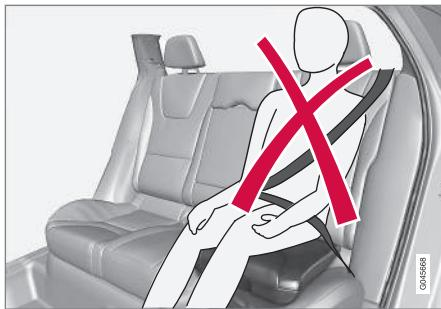
Placement incorrect, l'appuie-tête doit être réglé à la même hauteur que la tête et la ceinture ne doit pas se trouver sous le niveau de l'épaule.
