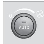
Tournez la molette pour augmenter ou réduire la vitesse du ventilateur. Si **AUTO** est sélectionné, la vitesse du ventilateur est régulée automatiquement (p. 136) - le réglage de la vitesse du ventilateur est annulé.
