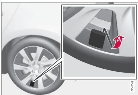
Dévissez le capuchon de valve et branchez le flexible du compresseur sur la valve.
