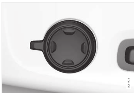
Multifunktionsknappen, i biler med firevejslændestøtte*.
