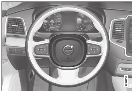
Hornet sidder midt på rattet.
