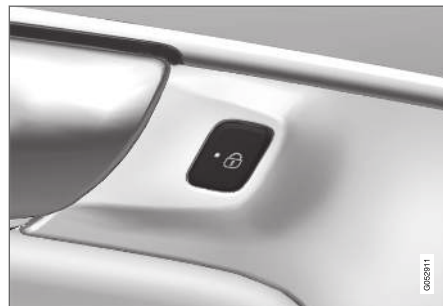
Knap til låsning i bagdør med indikeringslampe.
