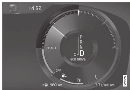
Eco-måleren på 12-tommer førerdisplay*.
