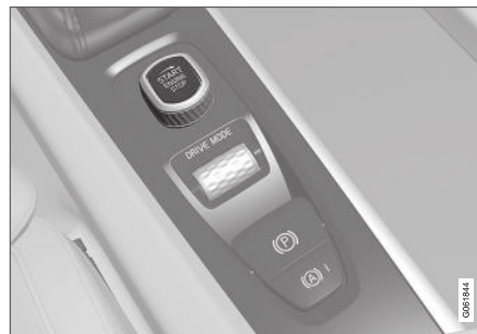
Startknappen i tunnelkonsollen.
