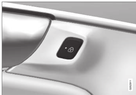
Låseknop med indikeringslampe i bagdør.
