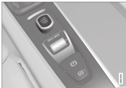
Startknappen i tunnelkonsollen.
