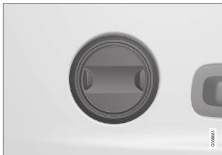
Regulatoren i biler med tovejslændestøtte*.
