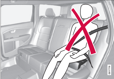
Yanlış konum, baş baş desteğinin üstünde olmamalı ve emniyet kemeri de omzun altından geçmemelidir.
