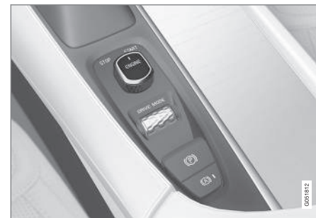
Startvredet i tunnelkonsolen.
