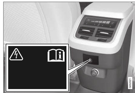
Sähköliitäntä tunnelikonsolissa, toinen istuinrivi.
