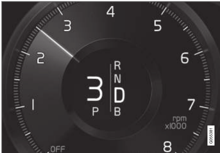
Kuljettajan näyttö vaihdettaessa ohjauspyörävalitsimilla.
