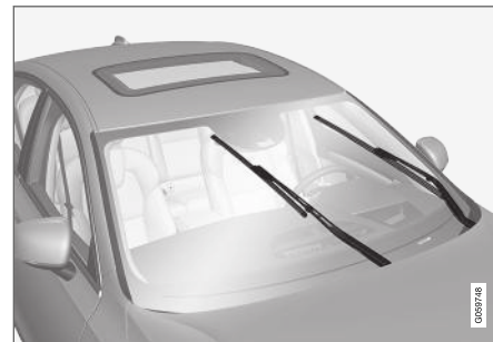
Balais d'essuie-glaces en position d'entretien.
