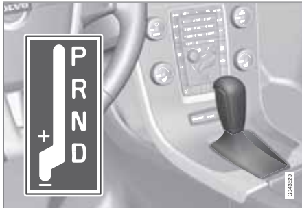
D: automatisch schakelen. + (–): handmatig schakelen.
