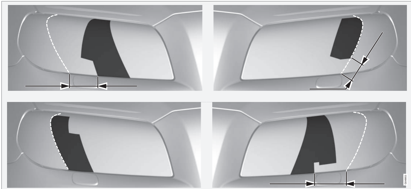
Bovenste regel: auto met stuur links, mallen A en B. Onderste regel: auto met stuur rechts, mallen C en D.
