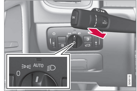
Stuurhendel en verlichtingsdraaiknop in stand AUTO .
