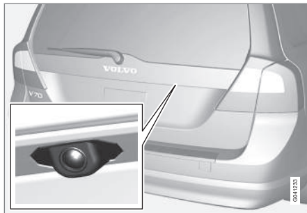
Cameraspositie bij de openingshandgreep.
