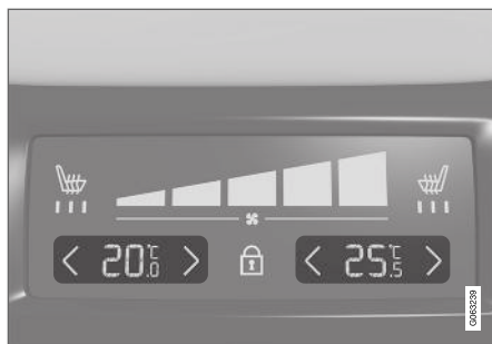
Hőmérséklet-vezérlés az alagútconsolek hátuljának klímapaneljén.
