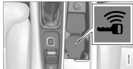
Localização do leitor no console de túnel.
