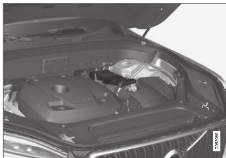
A bateria de apoio está em uma caixa junto da barra de torção.
