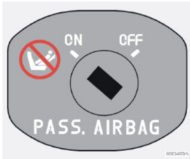
Conmutador para SRS en posición ON.
