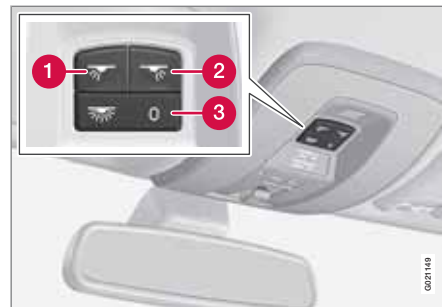
Górna konsola sterowania z wyłącznikami oświetlenia kabiny i przednich lampek oświetlenia do czytania.
