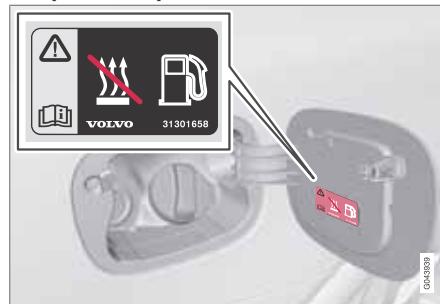
Etykieta ostrzegawcza na pokrywie wlewu paliwa.
