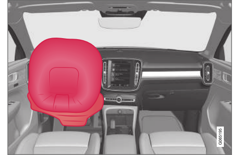
Ohjauspyörän turvatyyny ja polviturvatyyny 1 kuljettajan istuimella.
