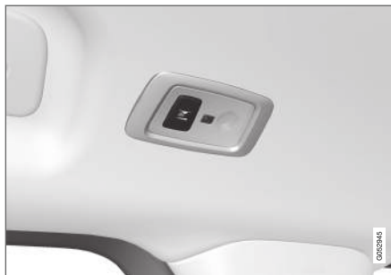
Panoraamakatonla* varustetussa autossa on kaksi valoyksikköä, yksi katon kummallakin puolella.
