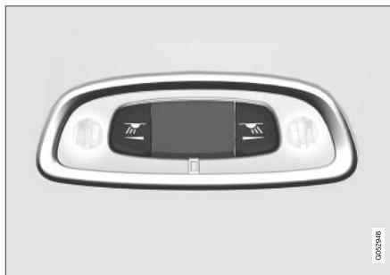
Lukuvalot takaistuimen yläpuolella.
