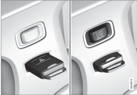
สวิตช์กุญแจที่ไม่มีกุญแจรีโมตคอนโทรลเสียบอยู่ และปุ่ม START/STOP ENGINE
