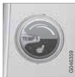
Premendo il pulsante una volta si ottiene il livello di riscaldamento max - 3 campi arancioni accesi sullo schermo della consolle centrale (vedere l'illustrazione sopra).
