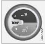
La temperatura sui lati conducente e passeggero può essere impostata separatamente. Premere ripetutamente il lato **L/R** del pulsante per selezionare il lato sinistro, il lato destro o entrambi.
