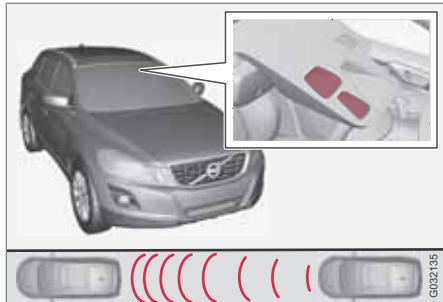
Finestre di trasmissione e ricezione del sensore laser<sup>1</sup>.
