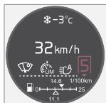
Nella versione "Analog" del cruscotto, le posizioni del cambio e le frecce indicatrici sono mostrate al centro del quadro strumenti.
