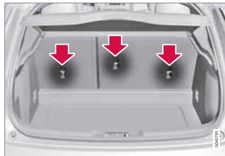
L'automobile è dotata di attacchi superiori per alcuni tipi di seggiolini per bambini orientati in avanti. Gli attacchi sono situati sul lato posteriore del sedile.
