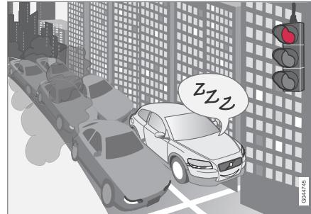
Alcune combinazioni di motore e cambio sono dotate di funzione Start/Stop che interviene, ad esempio, in coda o al semaforo - il motore si spegne temporaneamente e, al momento di rimettersi in marcia, si riavvia automaticamente.
