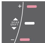
Indicatore del cambio manuale. È acceso un solo cursore per volta - durante la guida normale è acceso solamente quello centrale.
