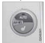
Ruotare la manopola per aumentare o ridurre la velocità della ventola, **AUTO** viene disinserito. Se si seleziona **AUTO**, la velocità della ventola si regola automaticamente - la velocità della ventola precedentemente impostata viene disinserita.
