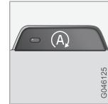
La funzione Start/Stop si attiva automaticamente all'accensione del motore con la chiave. Il conducente viene avvertito dello stato della funzione mediante la breve accensione di questo simbolo sul cruscotto, il messaggio **Auto Start-Stop ON** sul display e l'accensione della spia verde del pulsante ON/OFF.
