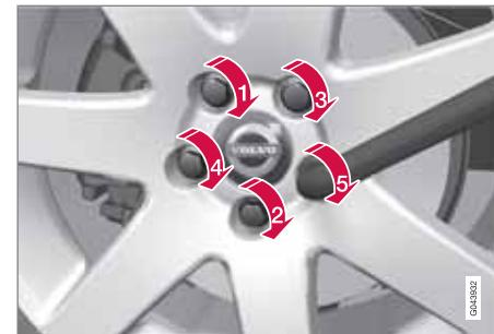
4. Serrare i dadi della ruota in sequenza. È importante serrare i dadi delle ruote alla coppia corretta (per le coppie di serraggio, vedere pagina 327). Controllare la coppia con una chiave torsiometrica.
