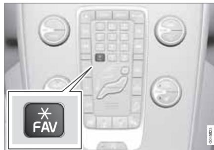
Il pulsante **FAV** permette di memorizzare le funzioni più utilizzate per attivarle facilmente premendo **FAV**. È possibile selezionare un'opzione preferita (ad esempio **Equalizzatore**) per ogni funzione come segue:
