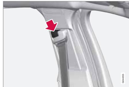
Impostazione dell'altezza della cintura di sicurezza. Premere il pulsante per impostare l'altezza della cintura. Posizionare la cintura più in alto possibile, senza che tocchi il collo.
