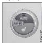
La funzione regola automaticamente temperatura, climatizzatore, velocità della ventola, ricircolo e distribuzione dell'aria.
