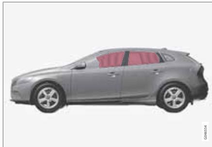
La tendina gonfiabile IC (Inflatable Curtain) fa parte del sistema SIPS e airbag. È montata nel padiglione su entrambi i lati dell'automobile e protegge i passeggeri nei sedili esterni. In caso di collisione sufficientemente forte, i sensori reagiscono gonfiando la tendina gonfiabile. La tendina gonfiabile contribuisce a proteggere la testa del conducente e dei passeggeri dai colpi contro l'interno dell'automobile in caso di collisione.
