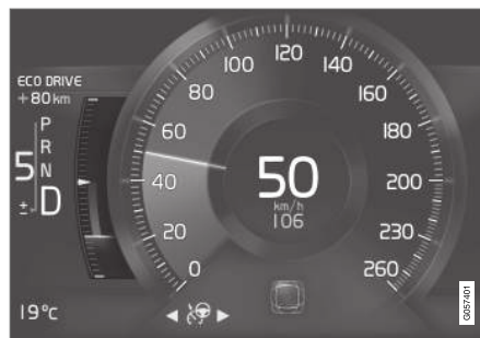
Eco műszer a 8-hüvelykes járművezetői kijelzőn.
