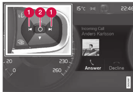
Példák üzenetekre a járművezetői kijelzőn 7 és a kormánykerék jobb oldali billentyűzete.
