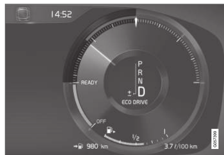
Eco műszer a 12-hüvelykes járművezetői kijelzőn*.
