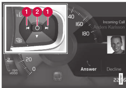
Példák üzenetekre a járművezetői kijelzőn 6 és a kormánykerék jobb oldali billentyűzete.
