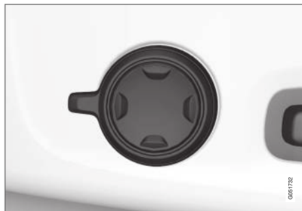
Többfunkciós kezelőszerv négyutas deréktámasszal* rendelkező autókban.
