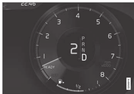
Дисплей водителя при переключении передач с помощью лепестков.
