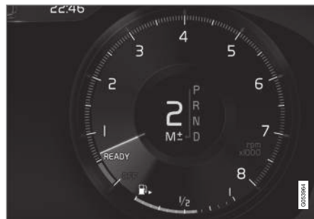
Положение переключения передач вручную на дисплее водителя 3 .
