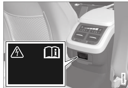
Электрическое гнездо в тоннельной консоли, заднее сиденье.
