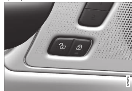
Кнопка для запирания и отпирания в передней двери и индикаторная лампа.
