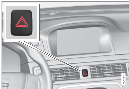
非常点滅灯ボタン
