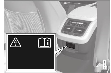
Stroomaansluiting in tunnelconsole, achterin.
