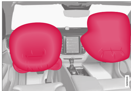
Coussins gonflables avant latéraux de conducteur/passager.
