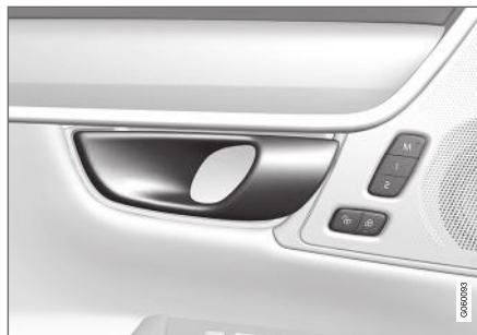
Méthode alternative de déverrouillage en utilisant la poignée d'ouverture de porte latérale 15 .
