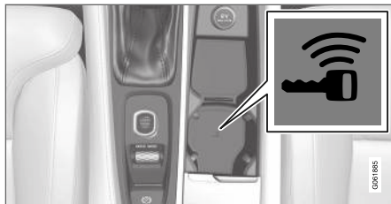
Emplacement du lecteur de clé de secours dans le porte-gobelet.
