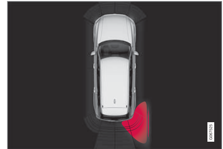
ไอคอนที่ติดสว่างขึ้นสำหรับ CTA ในภาพกราฟิก Park Assist System บนหน้าจอ
