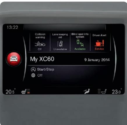
MY CAR 控制了汽車的許多功能，如 時鐘、車門後照鏡與車鎖的設定。
