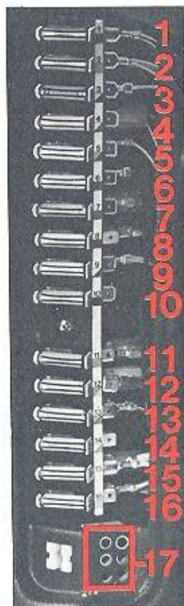
17 Gaten voor reservezekeringen
