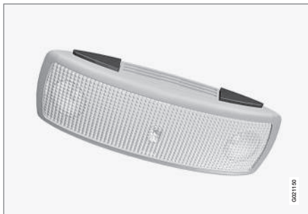
Потолочное освещение сзади.
