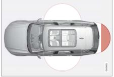
. توضح المنطقة المحددة في الرسم التوضيحي المناطق التي يغطيها الهوائي في النظام
