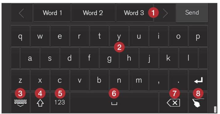
تعرض الصورة لمحة عامة عن بعض الأزرار التي قد تظهر في لوحة المفاتيح. يختلف المظهر باختلاف إعداد اللغة والمحتوى الذي يتم استخدام لوحة المفاتيح فيه.
