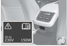
مقبس كهربائي بقوة ٢٣٠ فولت في كونسول النفق، بالمقعد الخلفي. يمكن استخدام المقبس الكهر بائي مع العديد من الملحقات بقوة ٢٣٠ فولت، مثل أجهزة شحن الهاتف الجوال والكمبيوتر المحمول.
