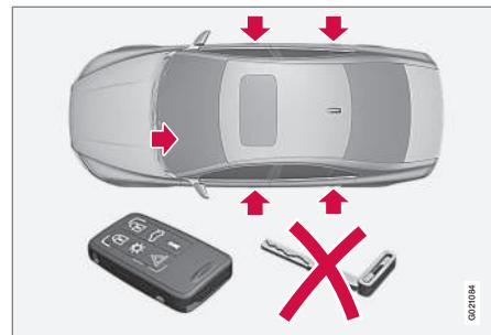
Points de verrouillage/déverrouillage en mode voiturier
