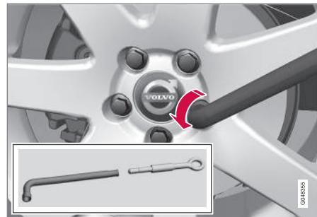
6. Avec le véhicule toujours au sol, retirer les caches en plastique des écrous de roue au moyen de l'outil fourni et utiliser la clé à roue/l'œillet de remorquage pour desserrer les écrous de roue d'1/2 à 1 tour en exerçant une pression vers le bas (dans le sens anti-horaire).
