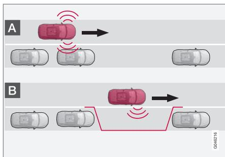
Le système PAP recherche un emplacement de stationnement potentiel et le mesure pour déterminer si l'espace est suffisant pour votre véhicule. Pour lancer cette procédure :
