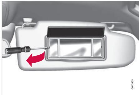
1. Insérer un tournevis sous le côté de la lentille et dégager soigneusement le tenon sur le bord.
