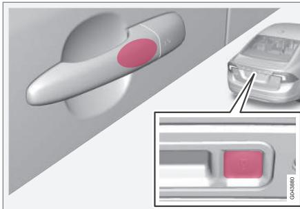
Les modèles équipés du démarrage sans clé possèdent une zone sensible à la pression sur les poignées de portières extérieures et un bouton couvert de caoutchouc près de la commande d'ouverture du coffre
