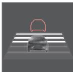
On peut choisir des intervalles de temps différents qui apparaîtront au tableau de bord<sup>2</sup> sous forme de 1 à 5 barres horizontales. Plus le nombre de barres est élevé, plus l'intervalle de temps est long. Une barre représente un intervalle de temps d'environ 1 seconde ; 5 barres représentent environ 3 secondes.
