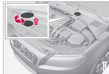
Emplacement du réservoir du liquide de frein
