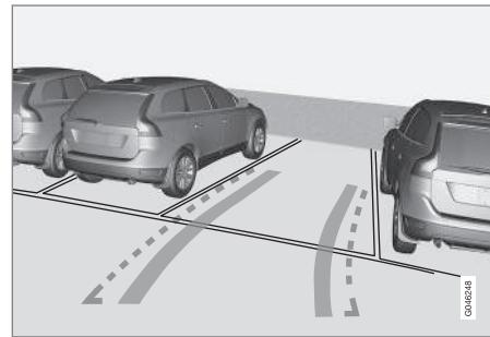
Les lignes à l'écran sont projetées comme si elles formaient un chemin sur le sol derrière le véhicule et bougent directement selon la manière dont on tourne le volant. Cela permet au conducteur de voir le chemin que prendra le véhicule, même s'il tourne le volant en reculant.
