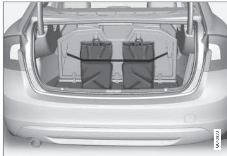
Dispositif d'arrimage des sacs d'épicerie sous le plancher du coffre
