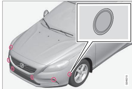
Illustration générique. Les capteurs PAP se trouvent sur les pare-chocs avant et arrière.
