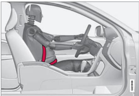
La ceinture doit être placée près du corps, le baudrier traversant le creux de la poitrine jusqu'au côté de l'abdomen. La partie ventrale de la ceinture doit être placée à plat au-dessus du haut des cuisses et le plus bas possible sous le ventre. Elle ne doit jamais être déplacée vers le haut. Éliminer tout mou dans la ceinture et s'assurer que celle-ci est bien ajustée au corps, sans entortillements.
