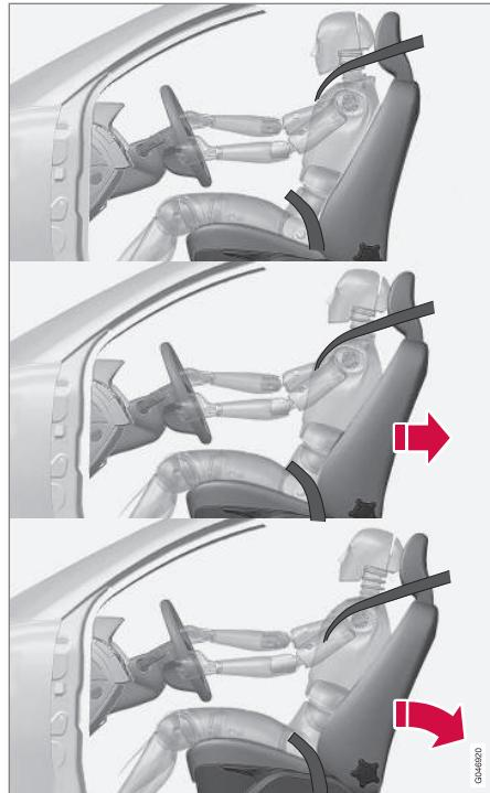
En cas de collision par l'arrière, les charnières et les supports des dossier des sièges avant sont conçus pour changer légèrement de position, afin
