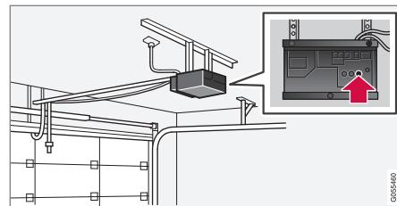
4. Repérer le bouton « learn » ou « smart » sur le récepteur de l'ouvre-porte de garage (boîtier). On le trouve généralement près de l'endroit où le fil d'antenne est raccordé au boîtier.
