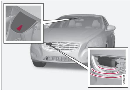
Caméra et capteur radar<sup>6</sup>.
