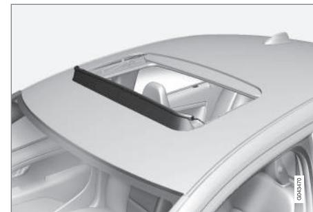
Le toit ouvrant est équipé d'un coupe-vent qui se plie lorsque le toit ouvrant est ouvert.
