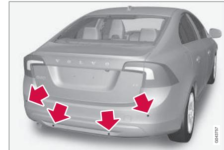
Emplacement des capteurs arrière
