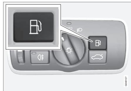
Avec le contact coupé, appuyer sur le bouton du panneau d'éclairage et le relâcher pour déverrouiller le volet du réservoir de carburant. Il est à noter que le volet du réservoir de carburant reste déverrouillé jusqu'à ce que le véhicule commence à avancer. Un clic se fait entendre lorsque le volet se verrouille de nouveau.
