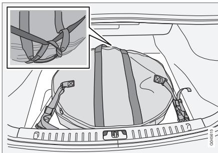
Tourner la poignée située sur le sac de la roue de secours en direction du siège arrière. Fixer les crochets de la courroie cousue dans les oeillets de chargement. Fixer la longue courroie dans l'un des oeillets de chargement, enruler la courroie autour de la roue de secours et à travers la poignée inférieure. Fixer la courroie courte sur la longue courroie. Fixer dans l'autre oeillet de chargement et serrer.
