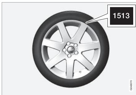
quents chargements lourds et l'exposition aux ultraviolets peuvent accélérer le vieillissement des pneus. La roue de secours à usage temporaire<sup>1</sup> devrait également être remplacée aux six ans même si elle n'a jamais été utilisée.
