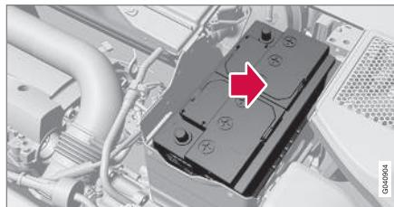
2. Déplacer la batterie vers l'intérieur et le côté jusqu'à ce qu'elle atteigne le bord du boîtier.
