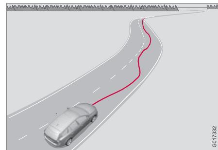
Une caméra surveille les lignes peintes qui délimitent la voie dans laquelle le véhicule roule et compare la direction de la route avec le mouvement du volant. Un signal prévient le conducteur si le véhicule ne suit pas régulièrement la voie.
