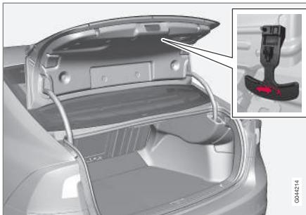
Le véhicule est équipé d'une poignée fluorescente sur la partie interne du couvercle du coffre; cette poignée permet d'ouvrir le coffre de l'intérieur en cas d'urgence. On doit abaisser la poignée pour débloquer le couvercle du coffre. Après utilisation, la poignée doit être repoussée en position initiale avant que le coffre puisse être refermé.
