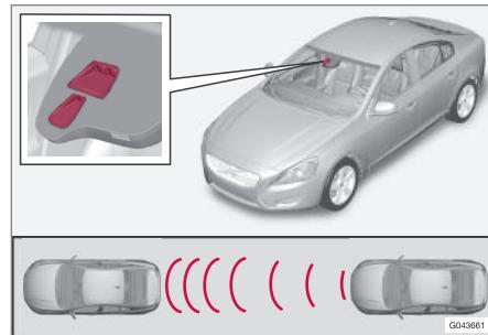
Emplacement du capteur laser dans le pare-brise<sup>5</sup>
