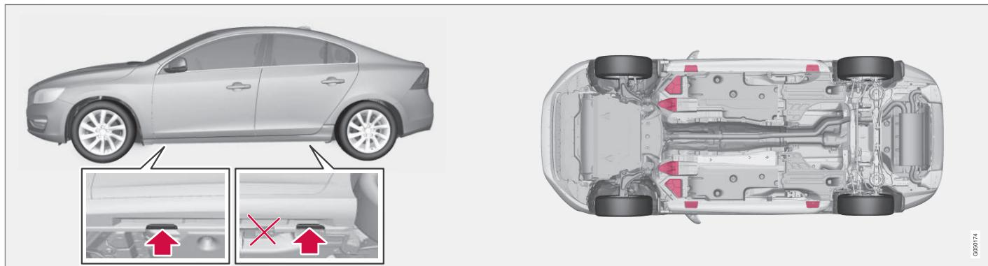
Si un cric de garage est utilisé pour lever le véhicule, il doit être placé :
