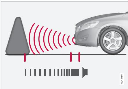
La distance mesurée à l'avant du véhicule est d'environ 0,8 mètre (2,5 pieds). Le signal est transmis par les haut-parleurs avant de la chaîne audio.
