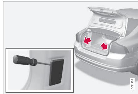
1. Insérer un tournevis et le tourner lentement pour desserrer le boîtier de l'ampoule.
