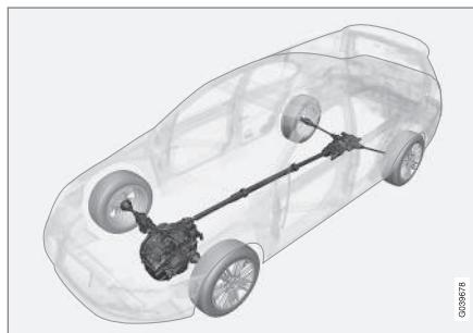
En temps normal, la plus grande partie de la puissance du moteur est dirigée vers les roues avant. Cependant, si les roues avant ont tendance à patiner, un dispositif de couplage commandé électroniquement envoie la puissance du moteur vers les roues qui ont la meilleure adhérence.
