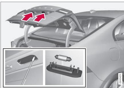
1. Retirer les vis à l'aide d'un tournevis.
