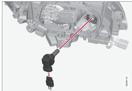
1. Déposer le boîtier de phare du véhicule (voir Ampoules - boîtier de phare (p. 358)).
