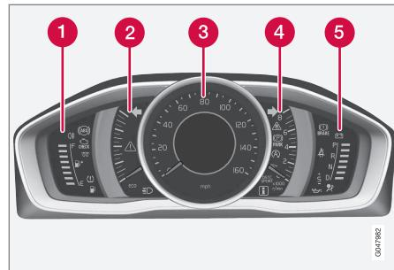
**1** Jauge de carburant : lorsque le témoin affiche un repère blanc<sup>1</sup>, un témoin jaune s'allume pour indiquer un niveau bas de carburant. Voir également Ordinateur de bord - introduction (p. 116) et Remplissage - exigences relatives au carburant (p. 296) pour de plus amples informations.
