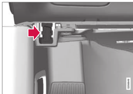
Datu saites savienotājs (On-board Diagnostic, OBDII) atrodas zem instrumentu paneļa vadītāja pusē.
