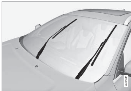
Az ablaktörlő lapátok a szervizállásban.
