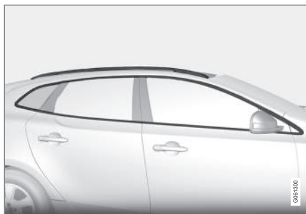
Alkatrészek, amelyek 3,5 és 11,5 pH-érték közötti tisztítószerrel moshatók.
